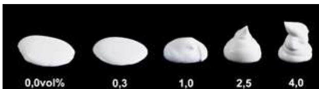
Abbildung 1: Keramische Kapillarsuspension aus Aluminiumoxid bei verschiedenen Anteilen an Zweitphase.
