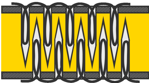
Figur 3: Verstärkung von Fügestellen durch Verstärkungsstifte. [Bild: Universität Stuttgart (ITFT), L. Born]
