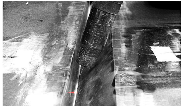
Abbildung: MSG-Schweißbrenner vor Beginn einer Mehrlagenschweißverbindung. Mittels Pyrometer (Positionierung roter Lichtpunkt) wird anschließend der Abkühlverlauf gemessen.
