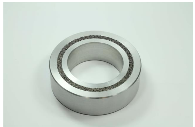
Abbildung 1: Prototyp der Dämpfungsschicht für ein Wälzlager (hier: Adapterring)
