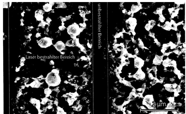
Abbildung 1: REM-Aufnahme der Siliziumschicht mit nicht bestrahltem und mit einem Laser bestrahltem Bereich
