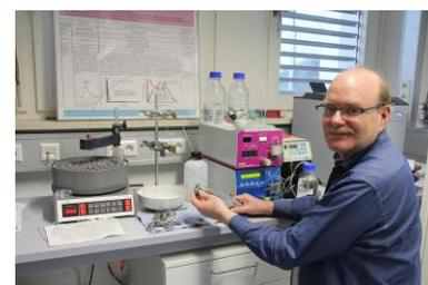
Die an der Hochschule Karlsruhe entwickelte Anlage zur inversen Flüssigchromatographie misst das Reaktionsverhalten von Silanen im Beton. Professor Dr. Andreas Gerdes zeigt eine Säule, die mit Beton gefüllt wird. Während die Pumpen das Silan durch die Säule leiten, zeichnet das System die Messwerte auf. Foto: Fernbacher
