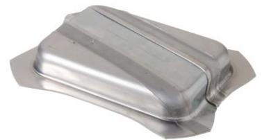
Exemplarische Technologiedemonstratoren von umgeformten hybriden Aluminium-Stahl Tailor Welded Blanks. (Fotos: Universität Stuttgart).
