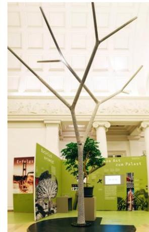
Verzweigte, geflochtene Tragkonstruktion bestehend aus Knotenelementen und geraden Stützen, Ausstellung *baubionik – biologie beflügelt architektur* Naturkundemuseum Stuttgart, Schloss Rosenstein. [Bild: University of Stuttgart (ITKE)]
