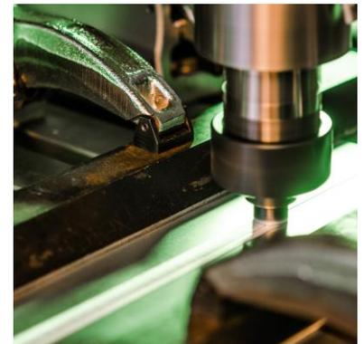
Durch Rührreibschweißen können Blechplatten aus Aluminium und Stahl gefügt werden. (Fotos: Mit freundlicher Genehmigung der MPA)
