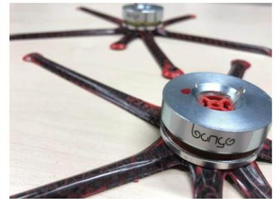
Forscher der Universität Stuttgart haben die Bauweise eines gehäuselosen Lautsprechers verbessert und ein neuartiges Federelement entwickelt, mit dem der Exciter ohne Kühlung auskommen kann.
