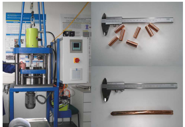
Prototyp der Umformvorrichtung, Rohlinge (o. re.) und Halbzeug (u. re)
