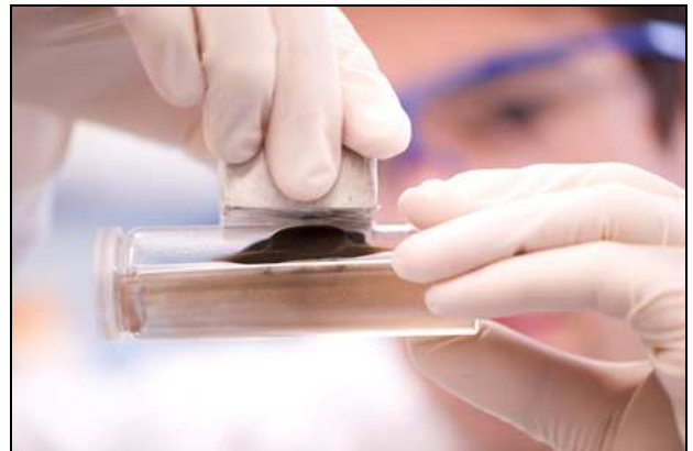
Abtrennen der neuartigen Magnetpartikel aus einer wässrigen Lösung (Bild: K. Dobberke für Fraunhofer ISC)
