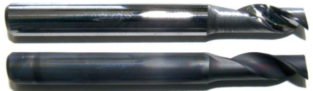
Abbildung 1: Diamantbeschichteter Fräser (unten), unbeschichteter Fräser (oben). © Foto Fraunhofer IWM
