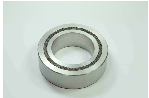
Abbildung 1: Prototyp der Dämpfungsschicht für ein Wälzlager (hier: Adapterring)
